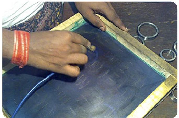
*Falsche Markierungen werden mit Siebdruck auf die Lager aufgebracht.*
